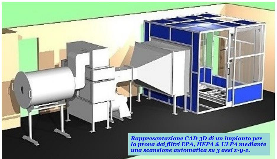
Rappresentazione CAD 3D di un impianto per la prova dei filtri EPA, HEPA & ULPA mediante una scansione automatica su 3 assi x-y-z.
