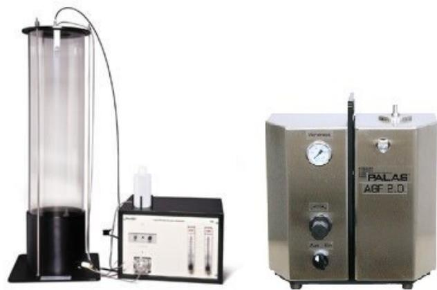
*Generatori di aerosol per particolato solido PM 2,5 e PM10 (foto a sinistra) e aerosol liquido per PM1 e MPPS (immagine a destra)*
