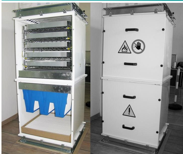
*Cabine di trattamento con vapore saturo di alcol isopropilico (IPA) con all'interno tasca rigida (e cella piana mini-pleat) da sottoporre a prova.*
