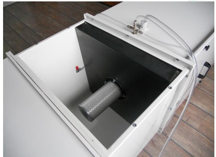
La sezione del tunnel di prova consente test su cartucce cilindriche con diametro fino a 450 mm e lunghezza 1500 mm max.
