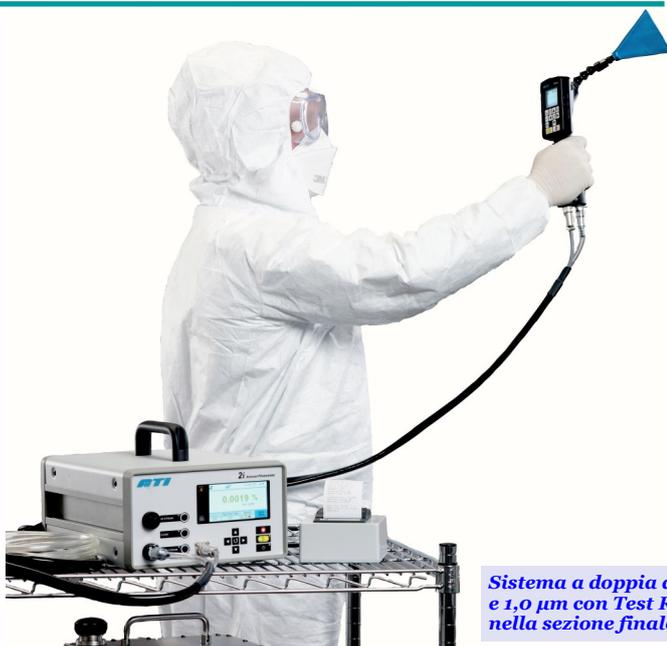
Sistema a doppia diluizione 1:1000 collegato a contatore di particelle nell'intervallo da 0,10 e 1,0  $\mu\text{m}$  con Test Report su MPPS (foto sopra). Test fotometrico con scansione manuale nella sezione finale del tunnel con sonda di campionamento "a becco d'oca" (foto a sinistra).
