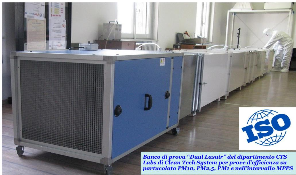
Banco di prova "Dual Lasair" del dipartimento CTS Labs di Clean Tech System per prove d'efficienza su particolato PM10, PM2,5, PM1 e nell'intervallo MPPS
